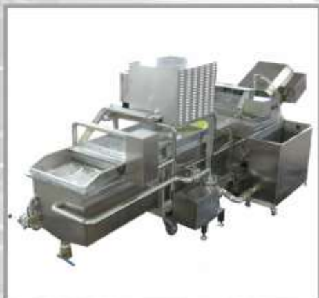
Мойка для фруктов и овощей Модель : QXJ-M Размер : 4355 x 1400 x 1630 мм Мощность : 7.5 кВт/ч Производительность : 3 тн/ч
