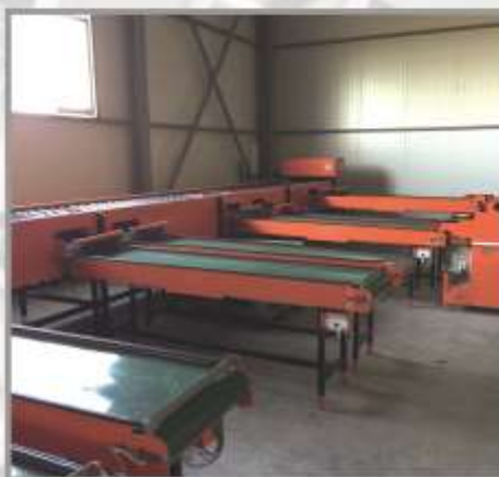
Линия по калибровке и сортировке свежих фруктов (косточковых) Размер : 18 x 6 x 2,8 м Мощность : 7 кВт/ч Производительность : 6 тн/ч
