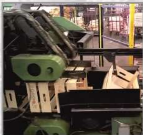
Автомат "степлер" Модель : M.271A Размер : 2200 x 1600 x 1400 мм Мощность : 4,2 кВт/ч Производительность : 4000-5000 шт/ч
