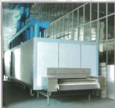
Сушилка ленточная Модель : SSD-2000 Размер : 19900 x 3600 x 2500 мм Мощность : 49 кВт/ч Производительность : 2 тн/сут.
