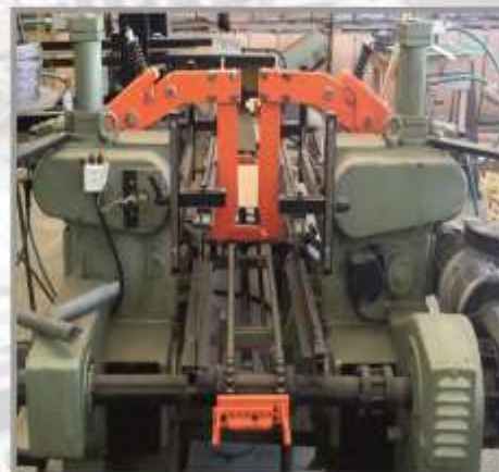
Станок для прошива дна ящика Модель : M.287A Размер : 5600 x 1200 x 1700 мм Мощность : 4,7 кВт/ч Производительность : 2000-2500 шт/ч
