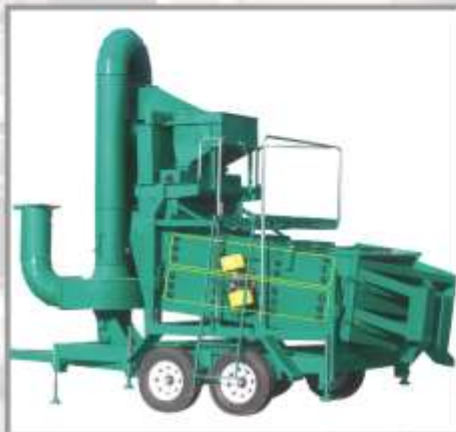
Станок по калибровке и сортировке Модель : 5XZF-7.5F Размер : 5600 x 2000 x 3200 мм Мощность : 14.85 кВт/ч Производительность : 7.5 тн/ч.
