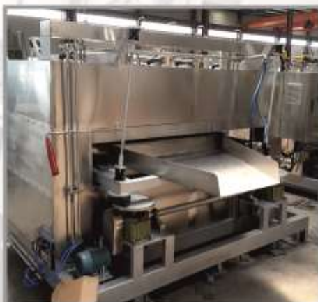
Жарочная печь Модель : HVO-400 Размер : 5500 x 5600 x 2600 мм Мощность : 4,2 кВт/ч Производительность : 0,4 тн/ч
