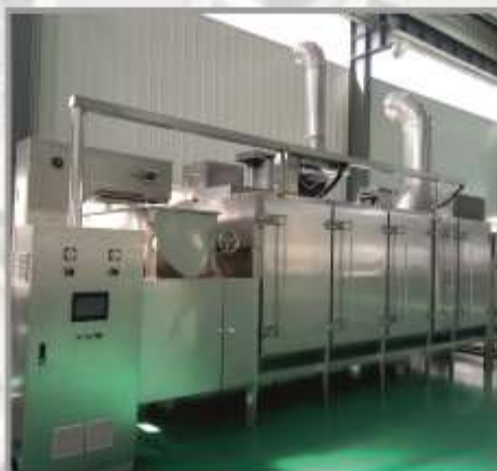
Жарочная печь Модель : MB-800 Размер : 5900 x 2800 x 3300 мм Мощность : 17 кВт/ч Производительность : 0,8 тн/ч
