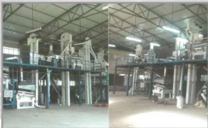
Линия по очистке, калибровке и сортировке бобов мунг (маш) Размер : 24 x 5 x 6,5 м Мощность : 32 кВт/ч Производительность : 8 тн/ч
