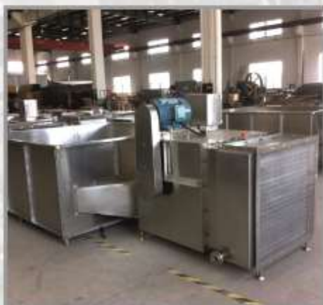
Сушилка (досушка) Модель : STJ-A Размер : 3170 x 3160 x 1000 мм Мощность : 2.2 кВт/ч Производительность : 0.5 тн/ч
