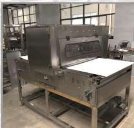
Машина для покрытия глазурью Модель : RYG-1000 Размер : 2550 x 1670 x 1820 мм Мощность : 15.75 кВт/ч Производительность : 1 тн/ч
