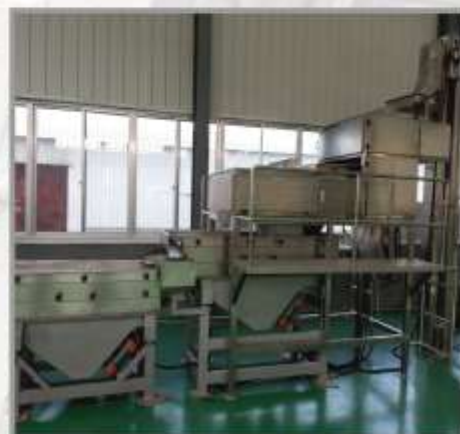
Мельница для арахиса Модель : PHGM-800 Размер : 3600 x 900 x 3200 мм Мощность : 3.7 кВт/ч Производительность : 0.8 тн/ч
