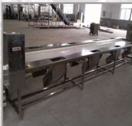
Инспекционный конвейер Модель : INT-5 Размер : 6000 x 850 x 850 мм Мощность : 0,75 кВт/ч Производительность : 5 тн/ч
