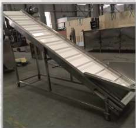
Наклонный конвейер Модель : DS3000 Размер : 3200 x 400 x 2200 мм Мощность : 0,75 кВт/ч Производительность : 3 тн/ч
