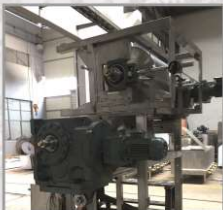
Машина для раскатки массы Модель : SGR-1000 Размер : 1600 x 1400 x 2600 мм Мощность : 3.95 кВт/ч Производительность : 1 тн/ч
