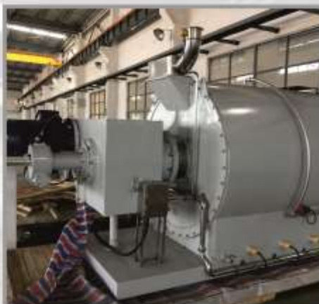
Блендер для шоколада (conche) Модель : JMS-2000 Размер : 3100 x 2000 x 2180 мм Мощность : 45 кВт/ч Производительность : 5.3 тн/ч
