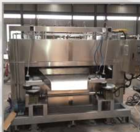
Жарочная печь Модель : HVO-300 Размер : 5500 x 5600 x 2600 мм Мощность : 3,8 кВт/ч Производительность : 0,3 тн/ч
