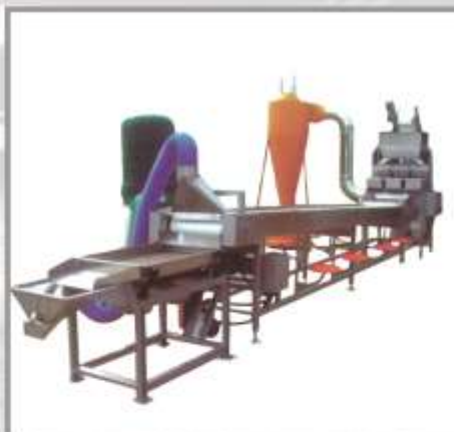
Линия по бланшированию ядра арахиса Размер : 9,5 x 1,2 x 2,4 м Мощность : 5,2 кВт/ч Производительность : 1,8 тн/ч
