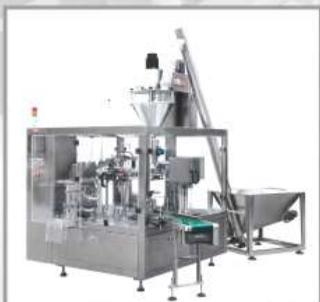
Упаковочная машина Модель : HT-6/8F Размер : 4200 x 2480 x 1700 мм Мощность : 4.5 кВт/ч Производительность : 1 тн/ч
