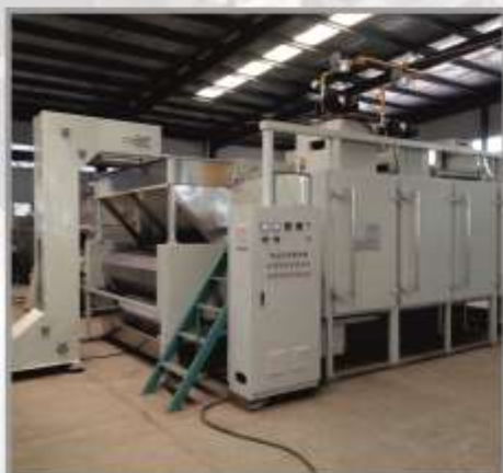
Жарочная печь Модель : MB-1500 Размер : 11100 x 2800 x 3300 мм Мощность : 28 кВт/ч Производительность : 1,5 тн/ч
