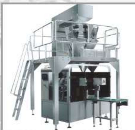
Упаковочная машина Модель : HT-8G/H Размер : 4500 x 2200 x 3700 мм Мощность : 4.5 кВт/ч Производительность : 1 тн/ч
