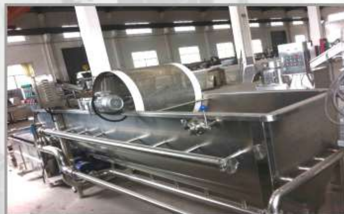
Мойка для фруктов и овощей Модель : WF-2000 Размер : 4200 x 1100 x 1100 мм Мощность : 3.5 кВт/ч Производительность : 2 тн/ч
