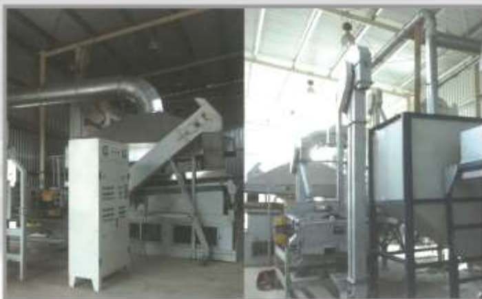
Линия по очистке, калибровке и сортировке семян Размер : 20 x 10 x 5 м Мощность : 22 кВт/ч Производительность : 1 тн/ч
