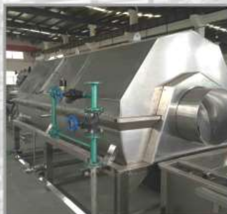
Овощечистка с бланшированием Модель : SPT Размер : 2800 x 1300 x 1700 мм Мощность : 3.4 кВт/ч Производительность : 3 тн/ч
