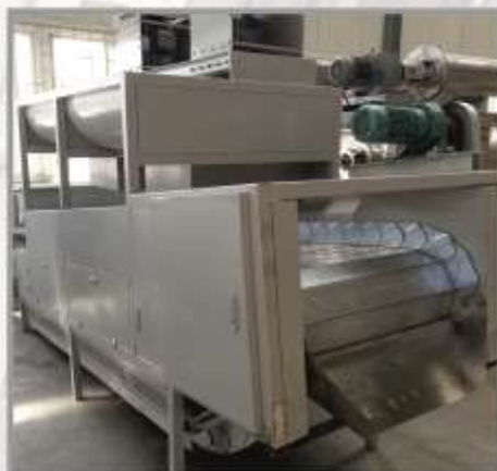
Жарочная печь Модель : HVO-600 Размер : 6500 x 2300 x 2600 мм Мощность : 5,6 кВт/ч Производительность : 0,6 тн/ч
