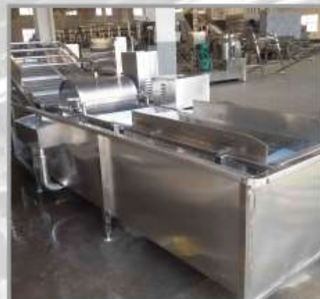
Мойка для фруктов и овощей Модель : QXJ-LM Размер : 4700 x 1500 x 1370 мм Мощность : 4.4 кВт/ч Производительность : 3 тн/ч
