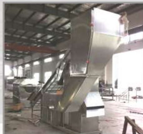
Резка для зелени Модель : FCJ Размер : 3800 x 800 x 3200 мм Мощность : 2.95 кВт/ч Производительность : 1.5 тн/ч
