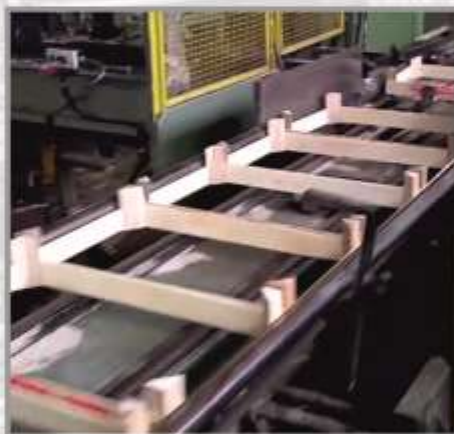
Станок "уголок" Модель : M.236A Размер : 4400 x 800 x 1400 мм Мощность : 3,5 кВт/ч Производительность : 2000 п/м в час
