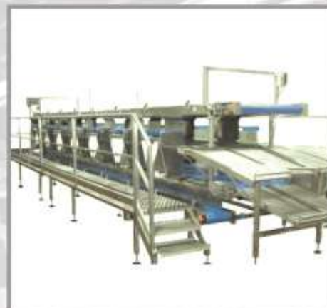
Линия по сортировке и калибровке свежих фруктов (косточковых) Размер : 18 x 6 x 2,8 м Мощность : 7 кВт/ч Производительность : 10 тн/ч
