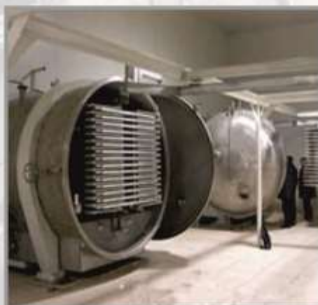
Сушилка вакуумная Модель : FDG-50 Размер : 540 x 635 x 300 мм Мощность : 40 кВт/ч Производительность : 50 кг/ч
