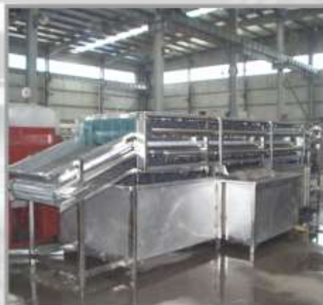
Мойка для зелени Модель : GXJ Размер : 5380 x 1500 x 1230 мм Мощность : 3.3 кВт/ч Производительность : 1.5 тн/ч
