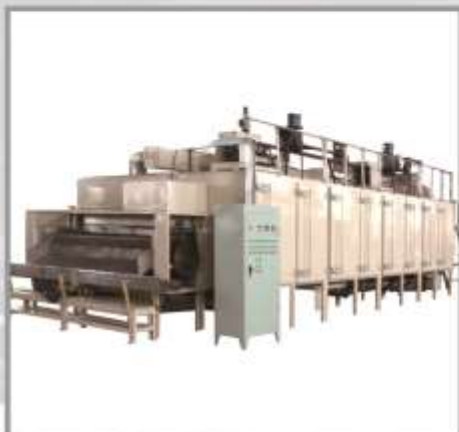
Жарочная печь Модель : MB-2000 Размер : 16000 x 2800 x 3300 мм Мощность : 34 кВт/ч Производительность : 2 тн/ч
