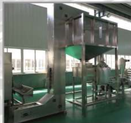
Конвейер вертикальный типа Z Модель : Z-3000 Размер : 5400 x 400 x 3500 мм Мощность : 0,75 кВт/ч Производительность : 3 тн/ч
