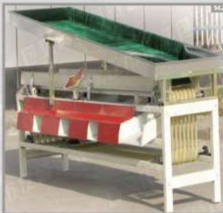
Калибровщик деликатный Модель : SM-1500 Размер : 34200 x 1100 x 2300 мм Мощность : 1.2 кВт/ч Производительность : 1.5 тн/ч
