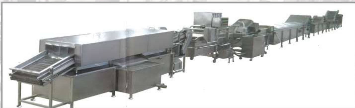
Линия по мойке, сортировке, бланшированию зелени и овощей Размер : 22,5 x 1,5 x 1,8 м Мощность : 19 кВт/ч Производительность : 3 тн/ч
