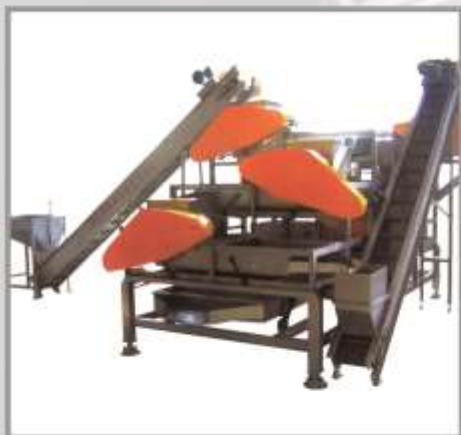
Шелушитель косточек Модель : ХНТК-А Размер : 3600 x 2300 x 2600 мм Мощность : 7,5 кВт/ч Производительность : 1,5 тн/ч
