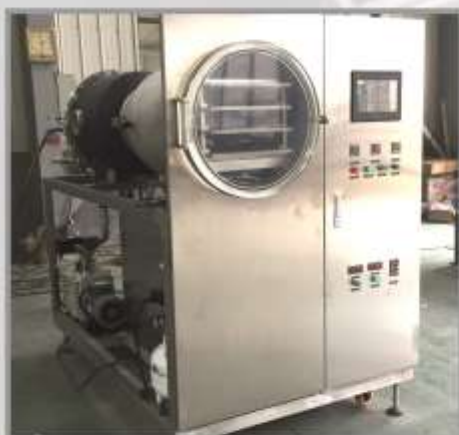
Сушилка вакуумная Модель : FDG-0.5 Размер : 2200 x 2800 x 2300 мм Мощность : 2 кВт/ч Производительность : 0.6 кг/ч
