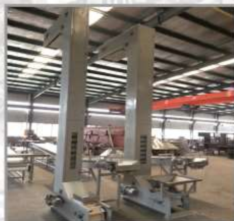
Вертикальный конвейер типа Z Модель : Z-3 Размер : 7400 x 400 x 5500 мм Мощность : 0,75 кВт/ч Производительность : 3 тн/ч
