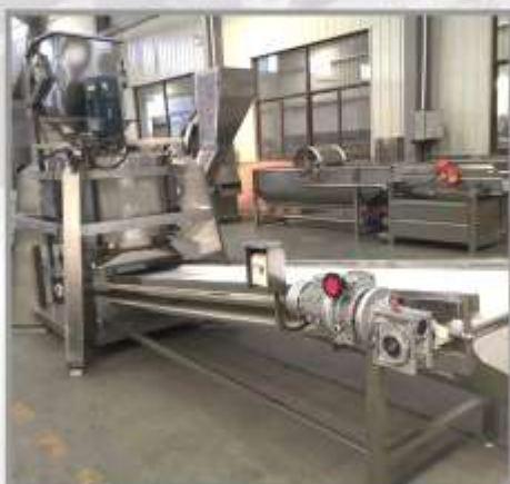
Центрифуга с конвейером Модель : SCCD-U-800 Размер : 5200 x 1200 x 2200 мм Мощность : 3.45 кВт/ч Производительность : 0.8 тн/ч
