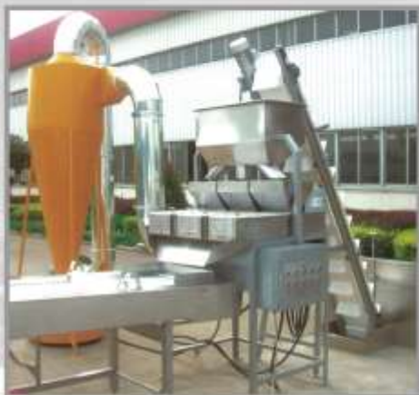
Бланширователь арахиса Модель : PBP-500 Размер : 12500 x 1200 x 3200 мм Мощность : 6.5 кВт/ч Производительность : 0.5 тн/ч
