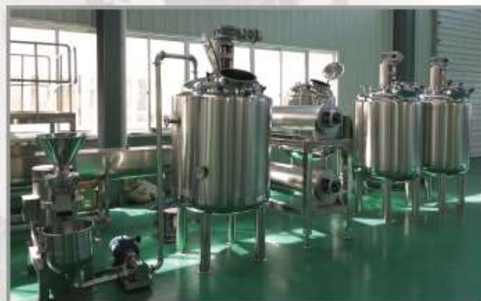
Реакторы разных модификаций Модель : RF-300 Размер : 1000 x 1000 x 2200 мм Мощность : 0.75 кВт/ч Производительность : 0.3 тн/ч
