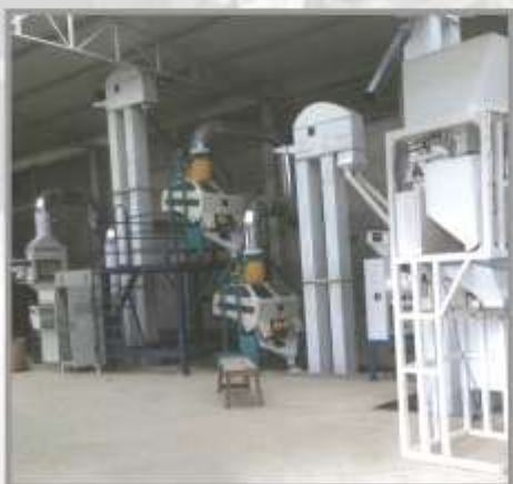
Линия по очистке, калибровке и сортировке кунжута Размер : 24 x 10 x 5 м Мощность : 24 кВт/ч Производительность : 5 тн/ч
