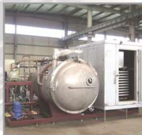
Сушилка вакуумная Модель : FDG-100 Размер : 540 x 635 x 300 мм Мощность : 40 кВт/ч Производительность : 100 кг/ч
