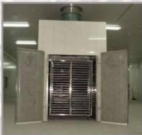
Сушилка туннельная Модель : SSJ-1 Размер : 11300 x 2580 x 3120 мм Мощность : 10.5 кВт/ч Производительность : 2.5 тн/сут.
