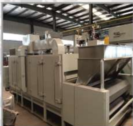
Жарочная печь Модель : MB-1000 Размер : 7360 x 2800 x 3300 мм Мощность : 23 кВт/ч Производительность : 1 тн/ч
