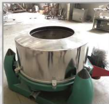
Центрифуга Модель : SSW-1000 Размер : 1300 x 1300 x 800 мм Мощность : 3 кВт/ч Производительность : 1 тн/ч
