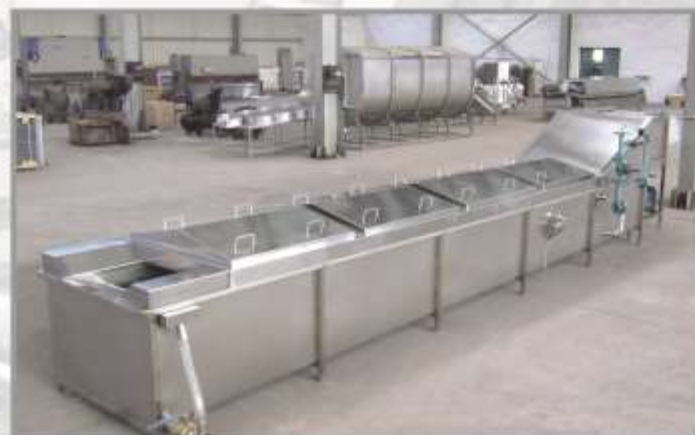
Бланширователь ленточный Модель : LPT Размер : 7370 x 1200 x 1280 мм Мощность : 2.6 кВт/ч Производительность : 3 тн/ч
