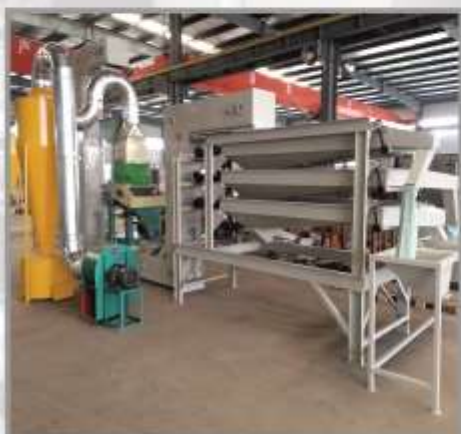
Калибровщик для сельхозпродукции Модель : SX-120 Размер : 3400 x 1500 x 2400 мм Мощность : 2.2 кВт/ч Производительность : 8 тн/ч
