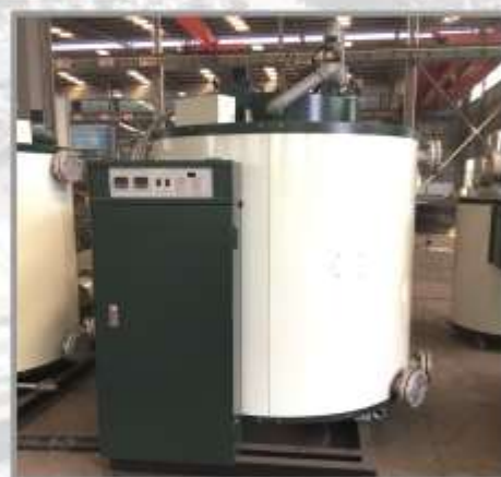
Паровой котел Модель : WNS 0,5-1.0-Y.Q Размер : 2100 x 2100 x 2400 мм Мощность : 4,1 кВт/ч Расход газа : 37 м3/час Производительность : 0,5 тн/ч пара
