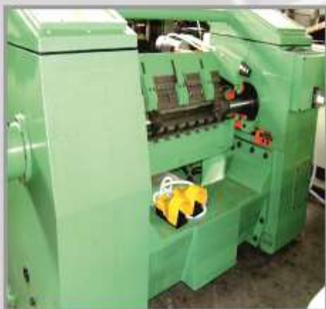
Станок для расщепления бревен на шпон и дощечку. Модель : M271-V1 Размер : 2600 x 2100 x 1700 мм Мощность : 3,8 кВт/ч Производительность : 30000 дощечек /ч
